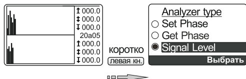
Рисунок 53 Включение в цп2 режима анализатора сети для оценки уровня сигнала
